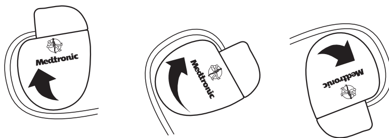
Figura 5. Rotirea dispozitivului pentru înfășurarea derivațiilor
