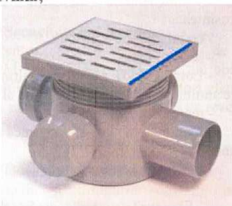
Sifon pardoseală 3 intrări D40mm și o ieșire D50mm
