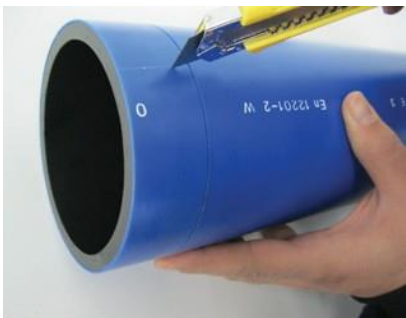
Cu bisturiu faceți o tăietură pe cercul stratului superior
