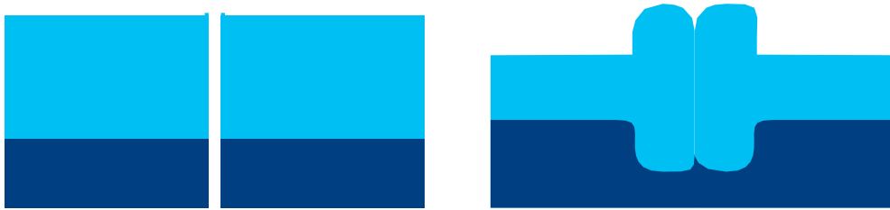
Alinierea și îmbinarea țevelor, sub presiune apar gulerășe
