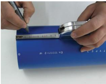
Măsurați și marcați țeava
