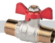
ONYX Kurek kulowy pełnoprzelotowy z dławikiem z motylikiem aluminiowym, wersja wkrętno-wkrętna
