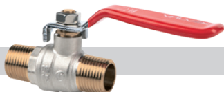
ONYX Kurek kulowy pełnoprzelotowy z dławikiem z dźwignią stalową, wersja wkrętno-wkrętna
