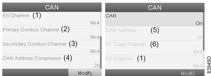
Меню настроек CAN в контроллере бойлера (слева) и в контроллере компрессора (справа)
