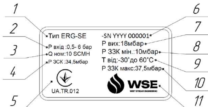
Рисунок 1 - Зразок лазерного маркування на корпусі регулятора
