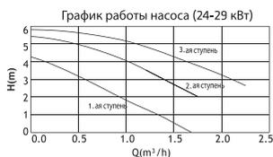
В конденсационных котлах 24 – 29 кВт Digifel Premix использованы 3-ступенчатые циркуляционные насосы марки Grundfos с низким энергопотреблением и высокой производительностью.
