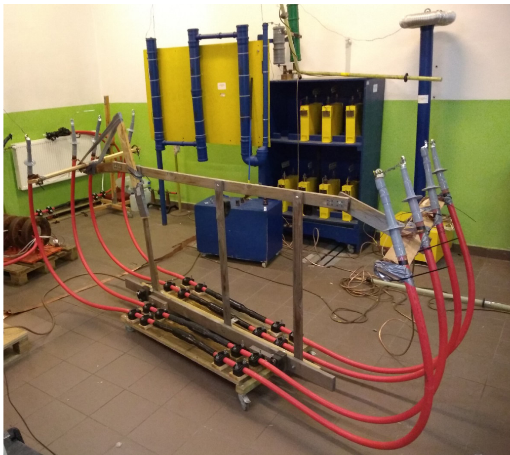
Rysunek 5. Widok obiektu badań podczas wytrzymałości elektrycznej krótkotrwałej w powietrzu napięciem AC: 2,5 \times U_0 , 15 min
