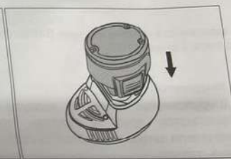
Рис 4. Установка батареи в зарядное устройство (обойма)
