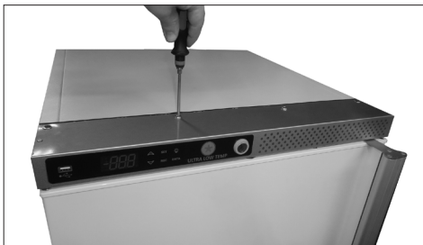
44. Remontați cele patru șuruburi superioare
