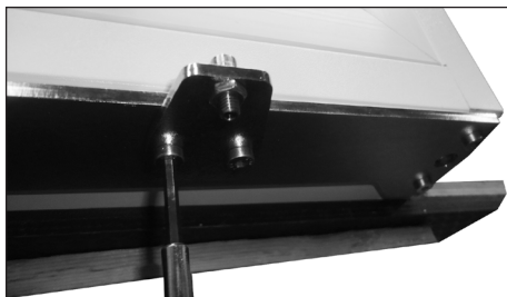
19. Scoateți placa inferioară a știftului de blocare a mânerului slăbind două șuruburi (utilizați cheia hexagonală de 4 mm)
