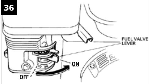
Fuel valve lever / Benzinhanh / Palivový kohout / Palivový kohút / Zawór paliwa / Üzemanyag elzáró csap
