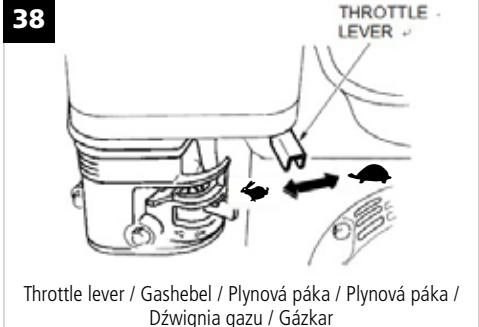
Throttle lever / Gashebel / Plynová páka / Plynová páka / Dźwignia gazu / Gázkar
