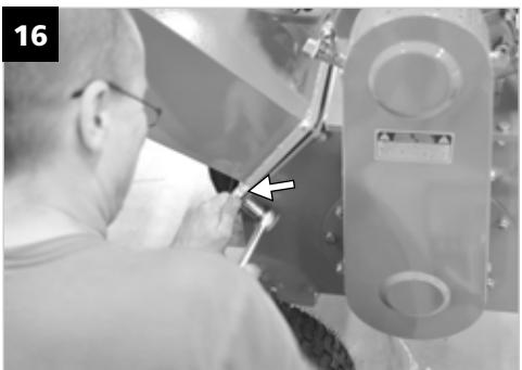
**CS** Na plnicí kanál namontujte madla (madla, šrouby a podložky naleznete v kufříku s náradím). Plnicí kanál přišroubujte k tělu stroje (5x M8). Po dotažení plniacího kanálu spojte v jeho dolní časti konektor ovládače zastavení.
