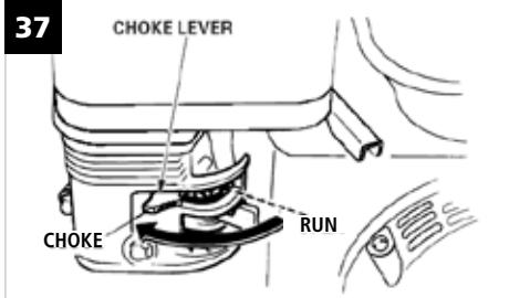
Choke lever / Chokehebel / Sytič / Sýtič / Ssanie / Szívató
