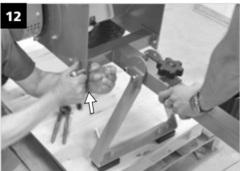
**SK** Na predný nosník s ojou namontujte prednú podperu (4x M8). Pridvihnite telo stroja na strane odhadzovacieho kanálu a namontujte predný nosník s ojou. Všetko pevne dotiahnite.
