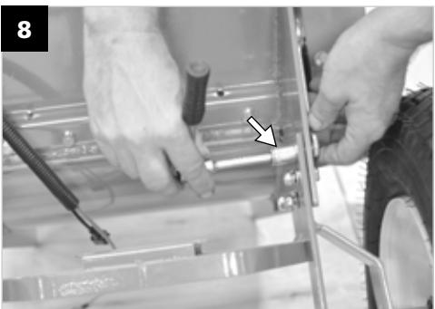
**HU** Szerelje fel az akkumulátor alapzatát (4x M8). Stabilan húzza be a kerekek tengelyét és az akkumulátor alapzatát is.
