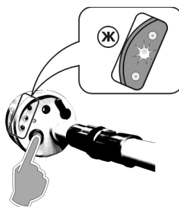
Рис. 6 Режим сигнализации разряда встроенного источника электропитания. Непрерывное свечение центрального желтого (Ж) светодиода, звук отсутствует.
