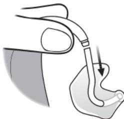
Отсоедините трубку и вкладыш от звукового крючка. При этом крепко держите аппарат за крючок, а не корпус. В противном случае вы можете повредить слуховой аппарат.
