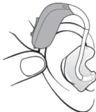
Осторожно потяните ухо наружу и вдавите ушной вкладыш в направлении слухового прохода, слегка проворачивая его.
