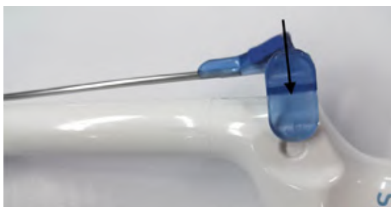
Figura 1-66. Împingerea în jos a ghidajului pentru biopsie
