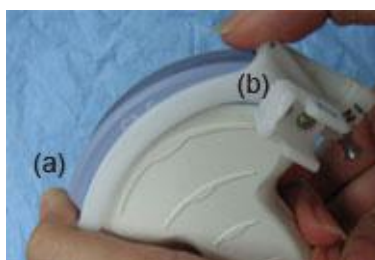
Figura 1-45. Aliniere sondă/suport multiunghiular 2
