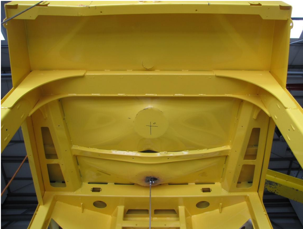
Bild (Picture) 6: Dachunterseite nach dem Test (roof underside after the test)
