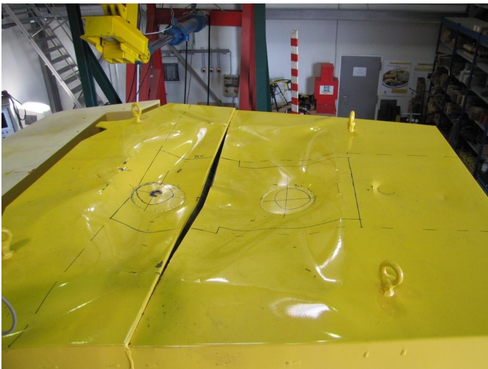
Bild (Picture) 5: Dachoberseite nach dem zweiten Fall (roof top after the second drop)
