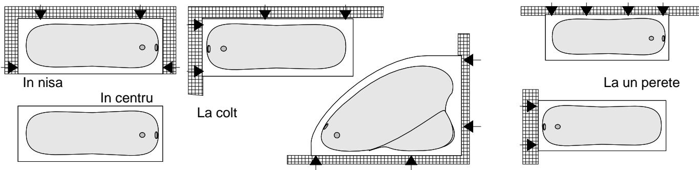
Montarea cazii cu sisteme speciale de prindere de zid si suport, ( montat sub fundul cazii ) se desfasoara astfel:
