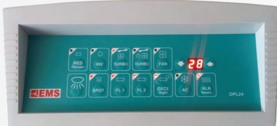
DPL-24 Kontrol Paneli, sistemin diğer bileşenleri olan kontrol sürücüsü (DRV-70), dokunmatik dijital kumanda paneli (DPL-70) ve el tipi kumanda (DPL-16) ile tam uyumlu olarak çalışmaya programlanmıştır. Tüm değişimler aktif olarak kontrol panellerinden takip edilebilir ve senkronize çalışma imkanı tanır.
