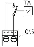
регулятор комнатной температуры (24В) подключается, как показано на схеме. Сначала необходимо снять перемычку на клеммной колодке с 2 контактами (CN5).
