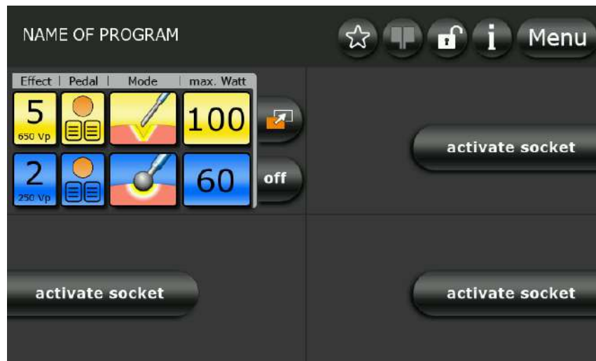
Bild 5-32: Top monopolar socket in Zap Mode
