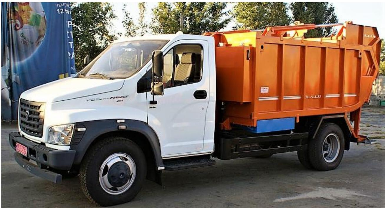
Мусоровоз Micro, с возможностью перегруза мусора в крупнотоннажные мусоровозы, (лицензия Zoeller, Германия) идеально подходит для использования в сложных условиях плотной застройки, в пешеходных и парковых зонах. Предназначен для механизированной загрузки твердых бытовых отходов из контейнеров объемом 60 – 1100 л (EN840/1, EN840/3) в бункер, их уплотнения и транспортировки к местам утилизации, также есть возможность загружать отходы в мешках, из уличных урн и не упакованный мусор.
