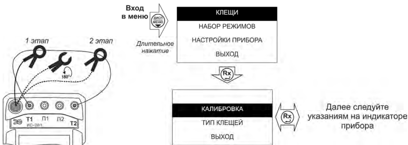
Рисунок 2.14 – Калибровка токоизмерительных клещей
