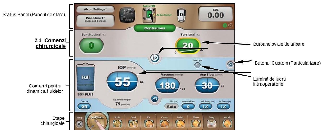
Figura 2-72 Fereastră Surgery Control (Control chirurgie) cu comenzile chirurgicale pentru facoemulsificare identificate
