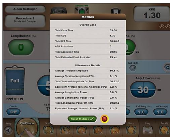
Figura 2-44 Caseta de dialog cu parametrii de evaluare și Total energie disipată (CDE)
