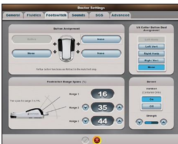
1. Setări medic: Atribuirea funcțiilor la butoanele întrerupătorului de picior Centurion ™.
