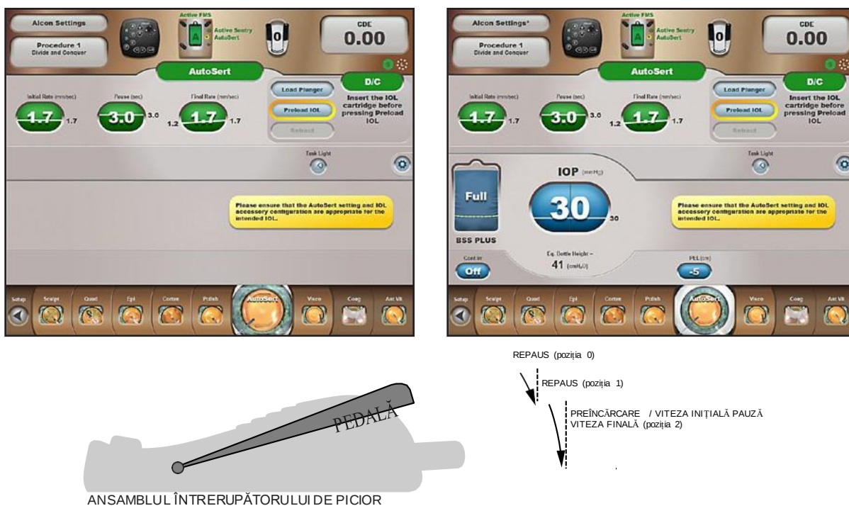
Figura 2-90 Ecranul Injectorului IOL AutoSert™
