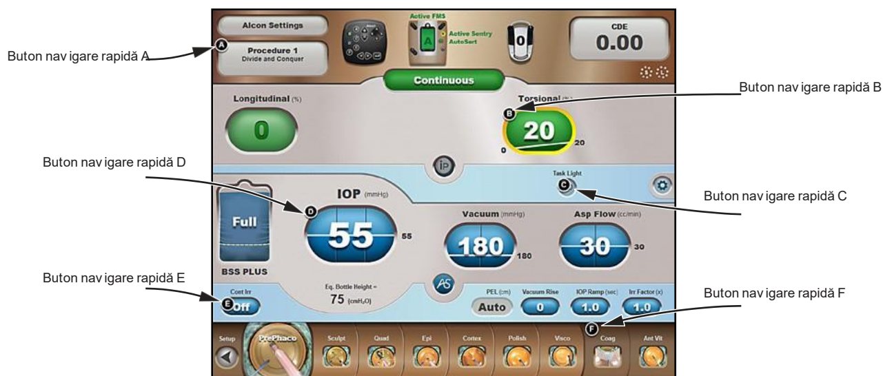
Figura 2-42 Butoanele de navigare rapidă ale telecomenzii în modul Continuous Phaco (Facoemulsificare continuă).
