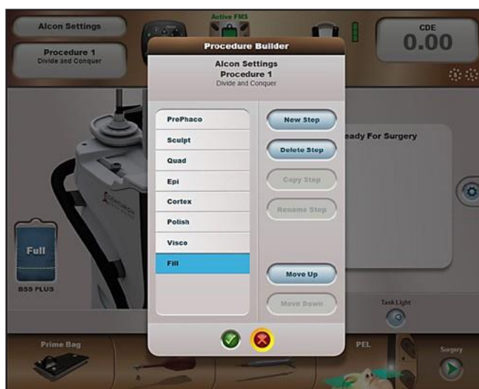
Figura 2-64 Caseta de dialog Procedure Builder (Configurare intervenții chirurgicale) cu etapa Fill (Umplere) adăugată În acest caz etapa Fill (Umplere) a fost selectată din coloana din dreapta a casetei de dialog Steps (Etape) (consultați figura anterioară). Etapa Fill (Umplere) apare în partea de jos a etapelor existente, după care s-a apăsă butonul Move Up (Deplasează în sus) pentru a muta etapa Fill (Umplere) după etapa Epi. Mai multe etape pot fi adăugate, șterse sau mutate înainte de a salva, prin apăsarea butonului verde de confirmare (✓).
