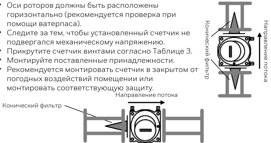
Рис. 11 | Установка конического фильтра
