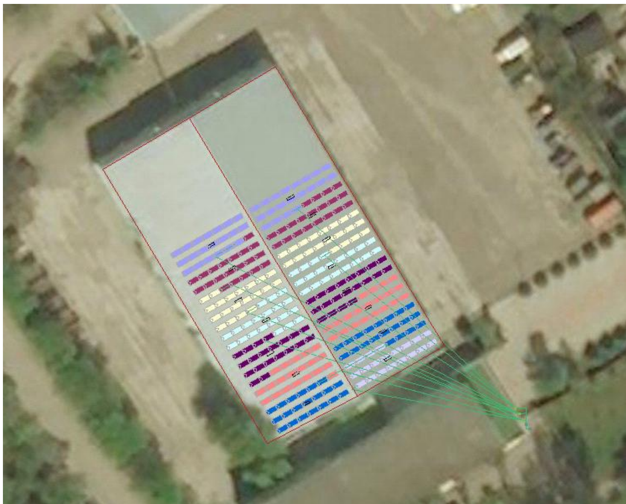
Figura 2b: Schita de amplasament al panourilor fotovoltaice si grupului de conversiune Sistem PV2 - 150 kWp
