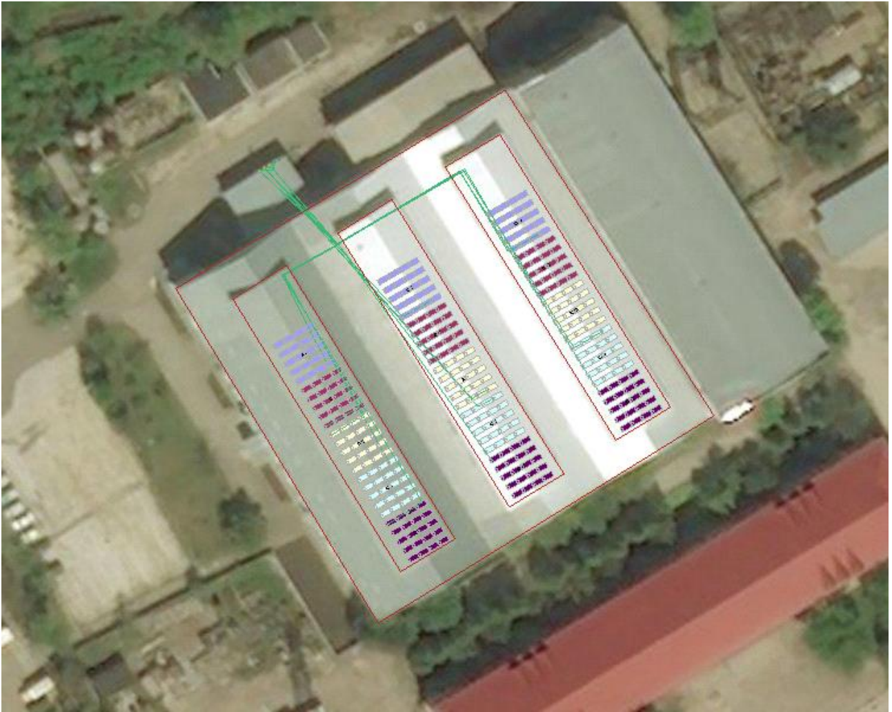
Figura 2a: Schita de amplasament al panourilor fotovoltaice si grupului de conversiune Sistem PV1 - 150 kWp
