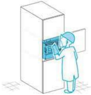
Ручное управление позволяет накапливать энергию, необходимую для включения или отключения аппарата. Расположенная на передней панели аппарата рукоятка управления служит для ручного взвода привода.
