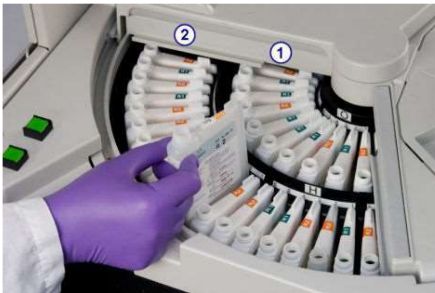
Figură 1.36: Centru de alimentare cu reactiv cu temperatură controlată (c4000)
