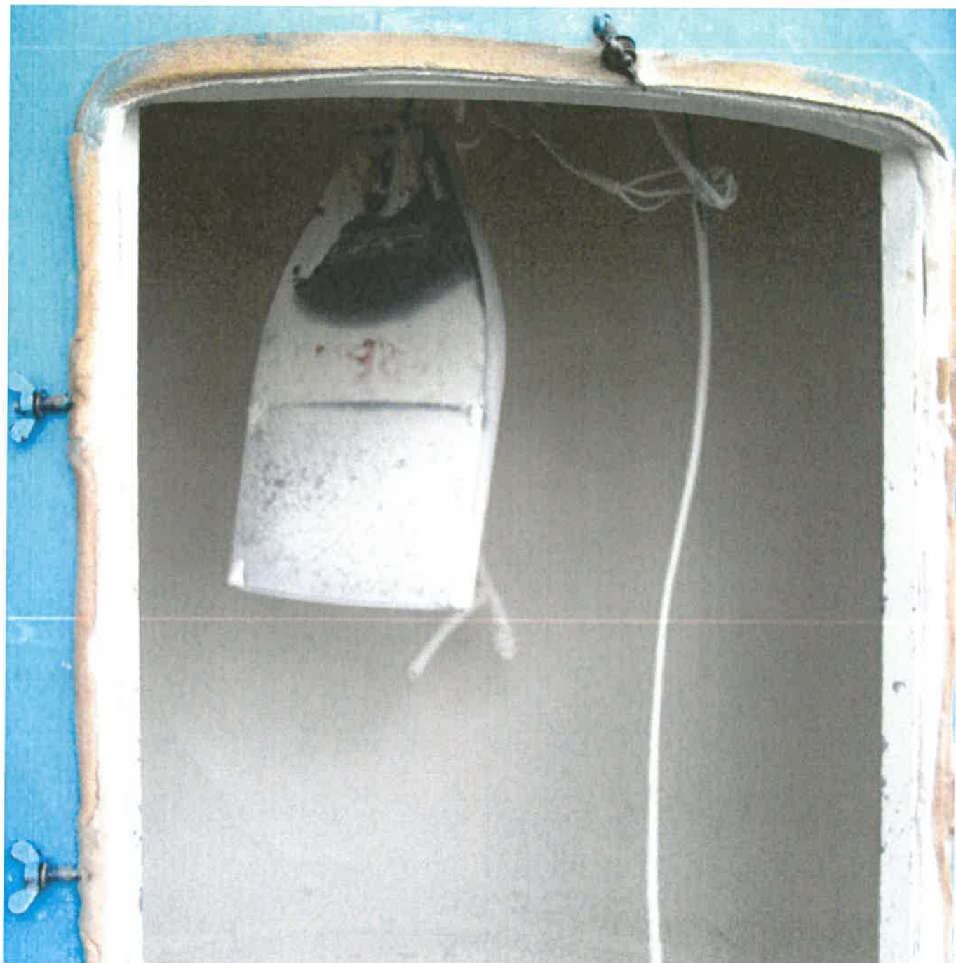
Figura 2 – Aparat de iluminat stradal tip Mesina M, 20 W-45 W, cod M45C2*1257DKSSA1, cu dispersorul montat, în camera de praf
