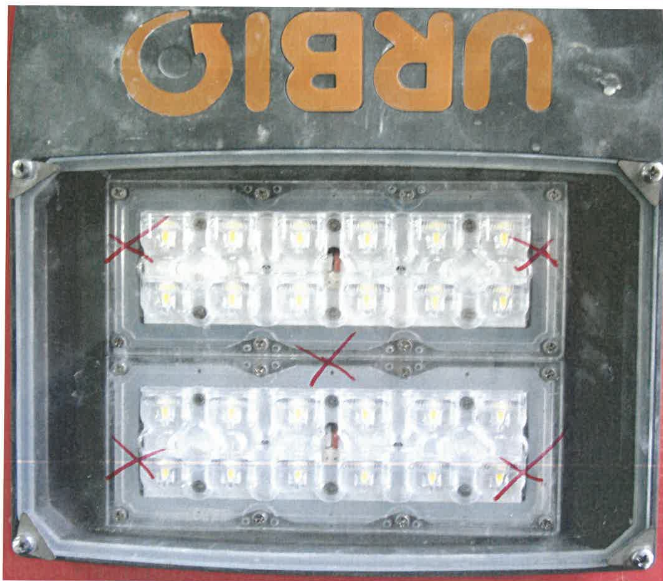
Figura 3 – Aparat de iluminat stradal cu LED-uri, tip Mesina M 20W-45W, cod M45C2*1257DKSSA1, cu dispersorul montat, după verificarea la IK10
