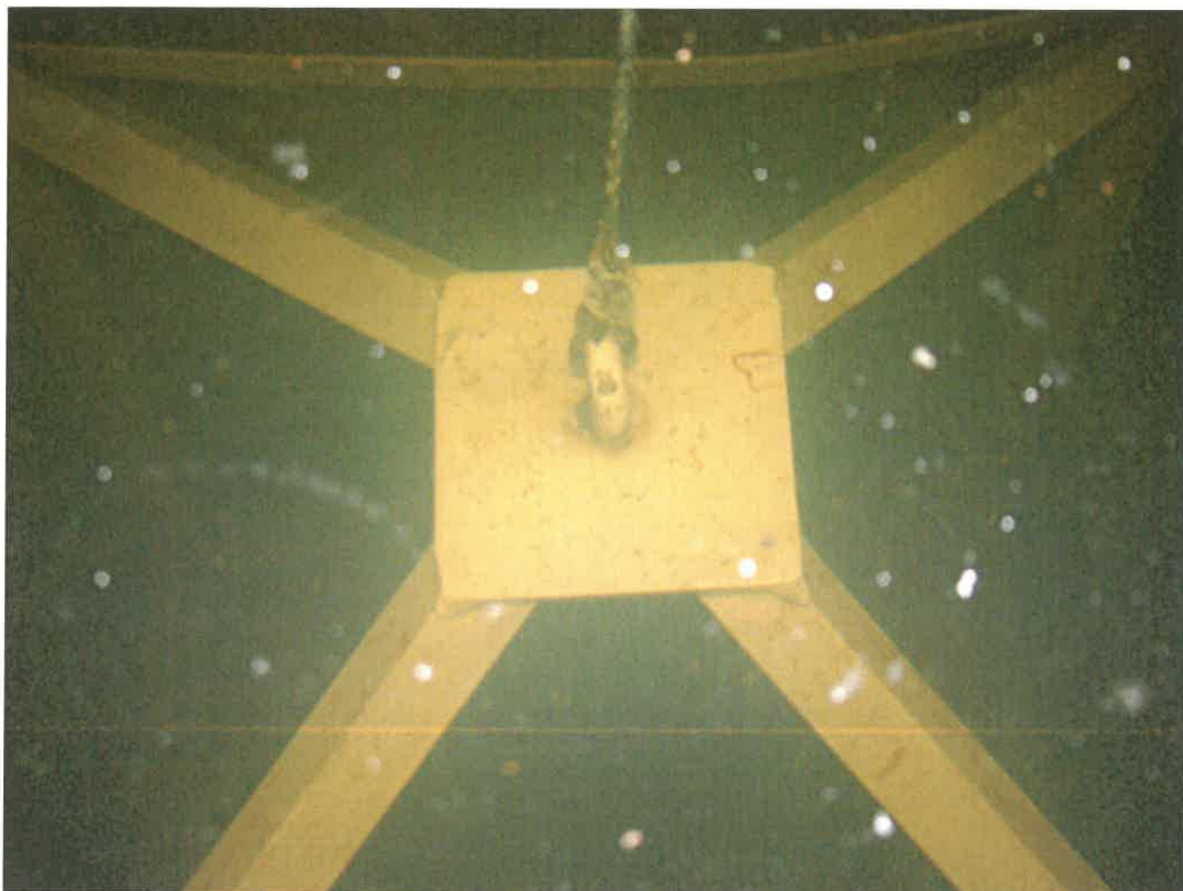
Figura 3 – Aparat de iluminat stradal tip Mesina M 20 W-45 W, cod M45C2*1257DKSSA1, cu dispersorul montat, introdus în bazinul cu apă
