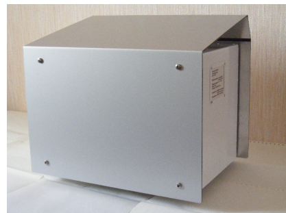
Рисунок 4 – Внешний вид корпуса, закрывающего трансформатор пробного напряжения.
