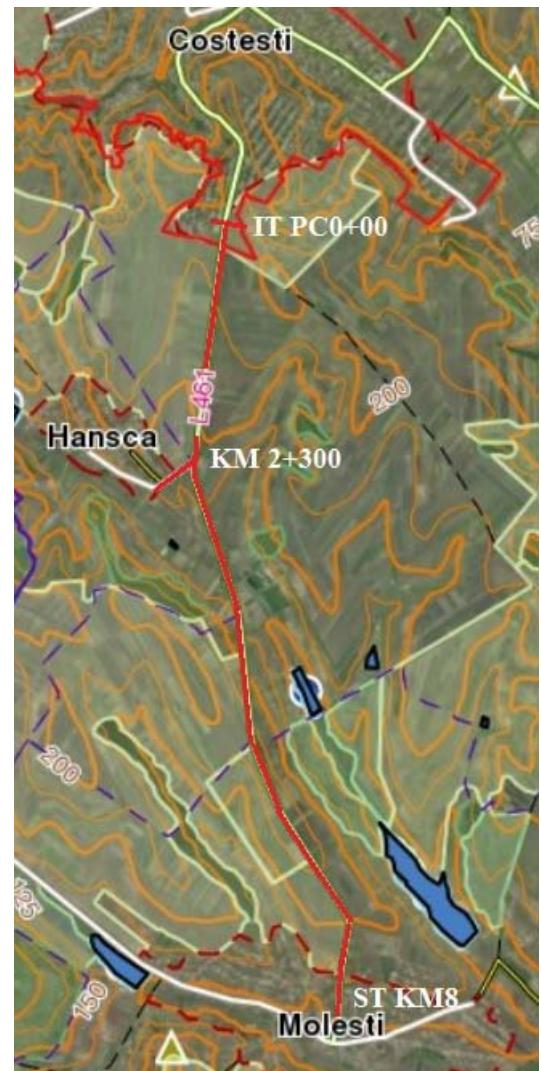
aproximativ 8,2km m (vezi plan încadrarea în teritoriu). Începutul traseului se găsește la Pc00+00 ieșirea din sat. Costești a traseului local L461, vezi fig.1. Sfârșitul traseului PC81+17 este intrarea în sat. Molești drum cu îmbrăcăminte din beton asfaltic.
