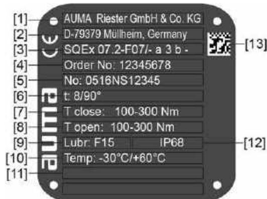
Figura 2: Plăcuța de identificare a actuatorului (exemplu)
