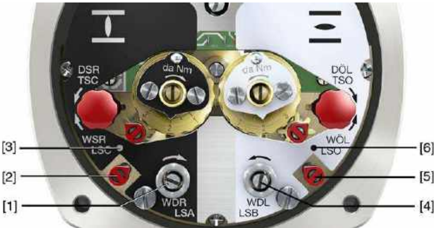
Figura 41: Elemente de setare pentru comutarea limită
