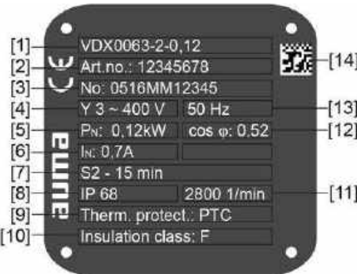
Figura 3: Plăcuța cu numele motorului (exemplu)
