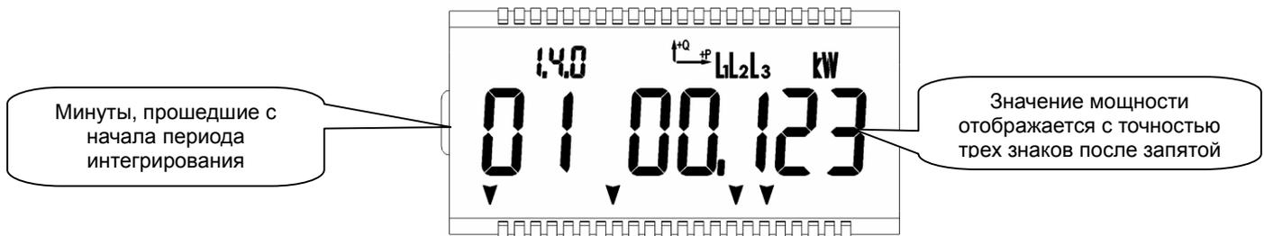
**Рис. 11: Отображение мощности текущего периода интегрирования**
