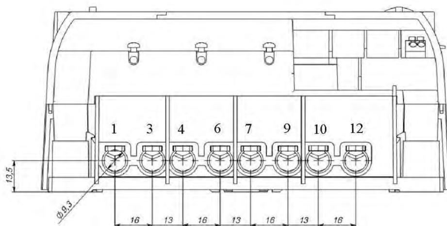
**Рис. 35: Контакты подключения сети для счетчиков прямого включения**
