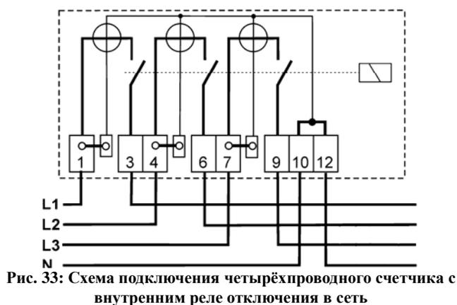
Рис. 33: Схема подключения четырехпроводного счетчика с внутренним реле отключения в сеть
