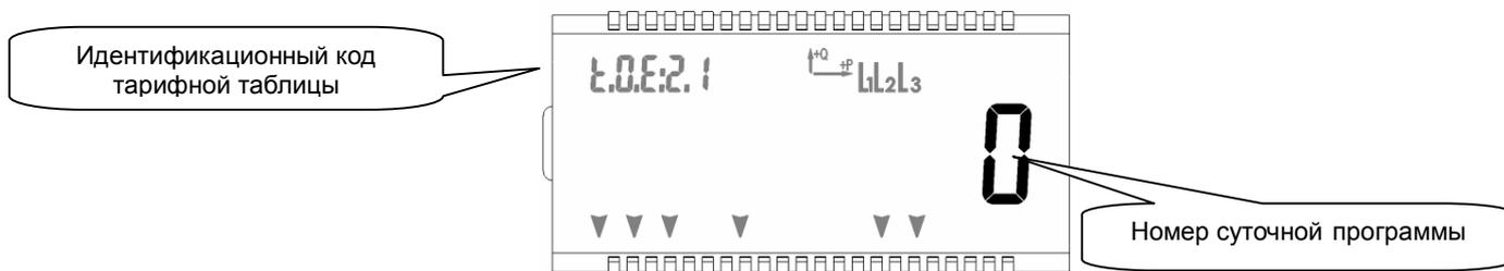
Рис. 23: Расположение Номера суточной программы на ЖКИ
