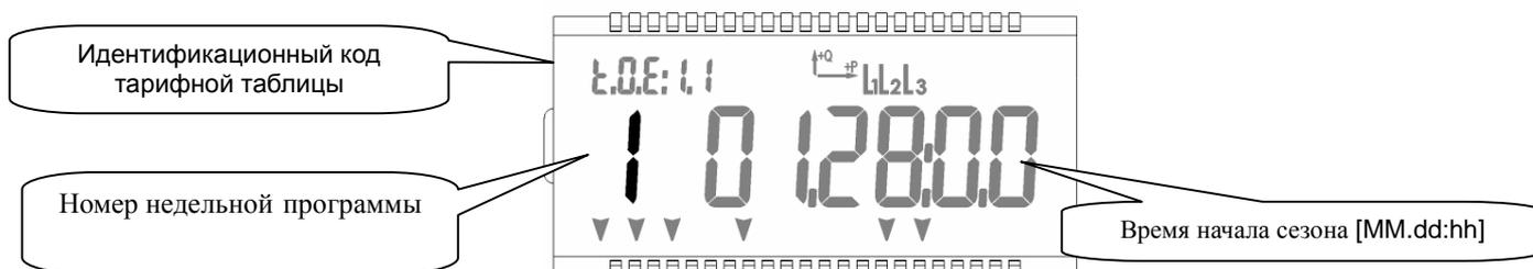
Рис. 22: Расположение Номера недельной программы на ЖКИ
