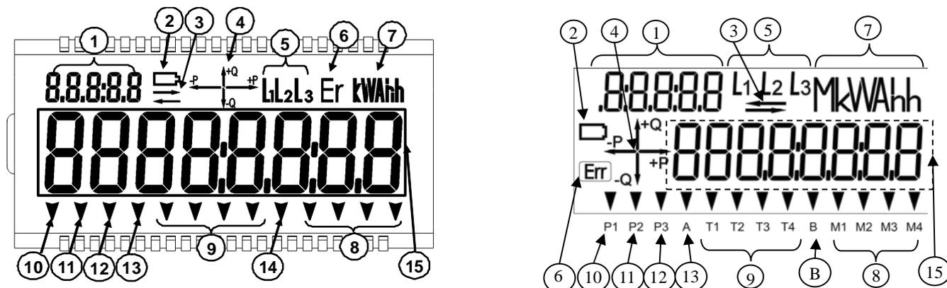
Рис. 4: Сегменты и поля ЖКИ счетчика G3B
