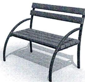
Banca este realizată din carcasă de oțel cu dimensiunile de 20x25 mm și cotiere din țevă de oțel cu dimensiuni de 40x25 mm. Suprafața băncilor este realizată din placaj rezistent la apă, cu grosimea de 30 mm.
