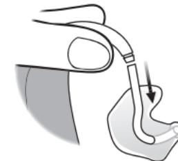
Отсоедините трубку и вкладыш от звукового крючка. При этом крепко держите аппарат за крючок, а не корпус. В противном случае вы можете повредить слуховой аппарат.
