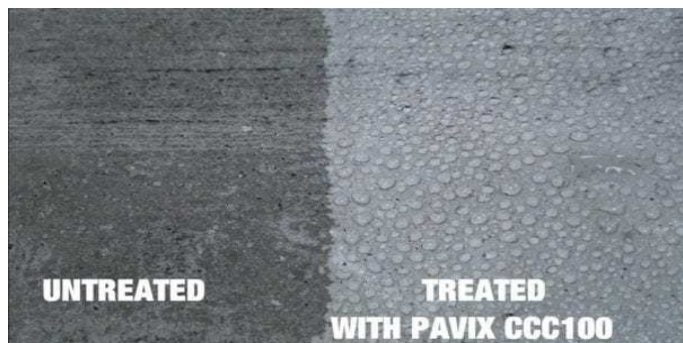
Figura 1: Unghiurile de contact ale apei ( \theta ) pe suprafețele din beton, comparând proba martor (stânga) și proba tratată cu Pavix (dreapta), utilizând rețeta de amestec pentru pavaje TX-DOT la un raport apă/ciment de 0,47.
