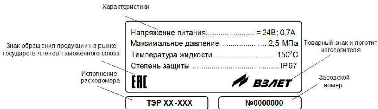
Рис.1. Шильд на блоке электроники расходомера.
