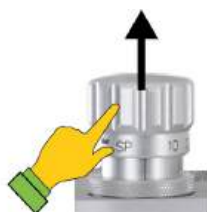
APL cu aerisire rapidă (ridicarea capului ventilului)
