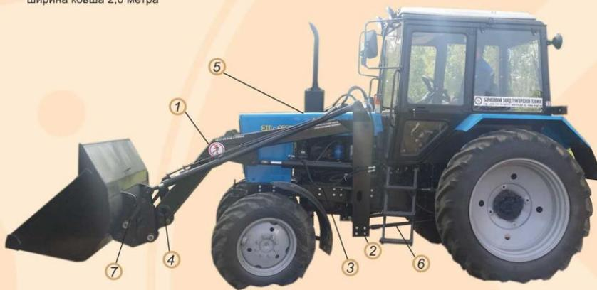
1. Накладка на стреле стальной толщиной 8 мм
