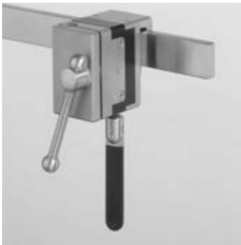
19799-05 Klemmsockel aus rostfreiem Stahl, für ein höhenverstellbares Stativ \varnothing 16 mm, elektrisch isoliert bis 4,5 kV AC, Spannweite 50 mm für Schienen 25/32 x 8/12 mm. Clamp socket made of stainless steel, for height-adjustable stand \varnothing 16 mm, electrically insulated up to 4.5 kV AC, holding width of 50 mm for rails 25/32 x 8/12 mm.
