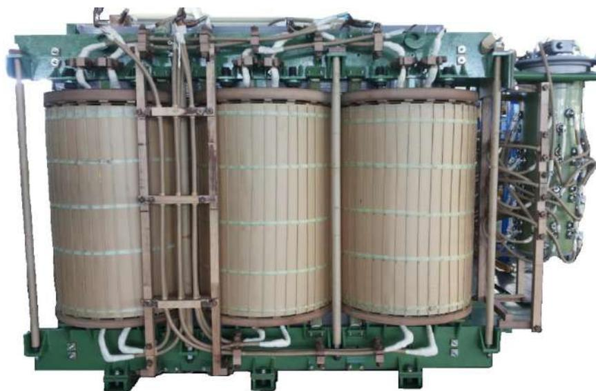
Рисунок 2.3.2 – Активная часть трансформатора
