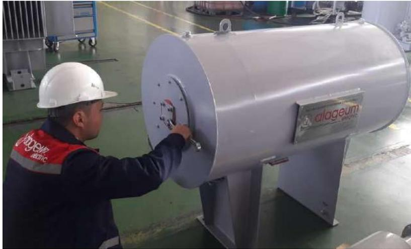
Рисунок 4.8 Снятие заглушки расширителя для установки маслоуказатели
