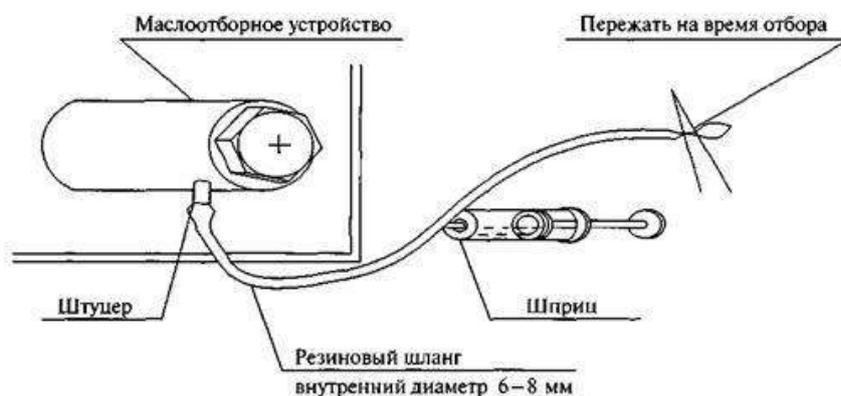
Рисунок . Схема маслоотборного устройства
