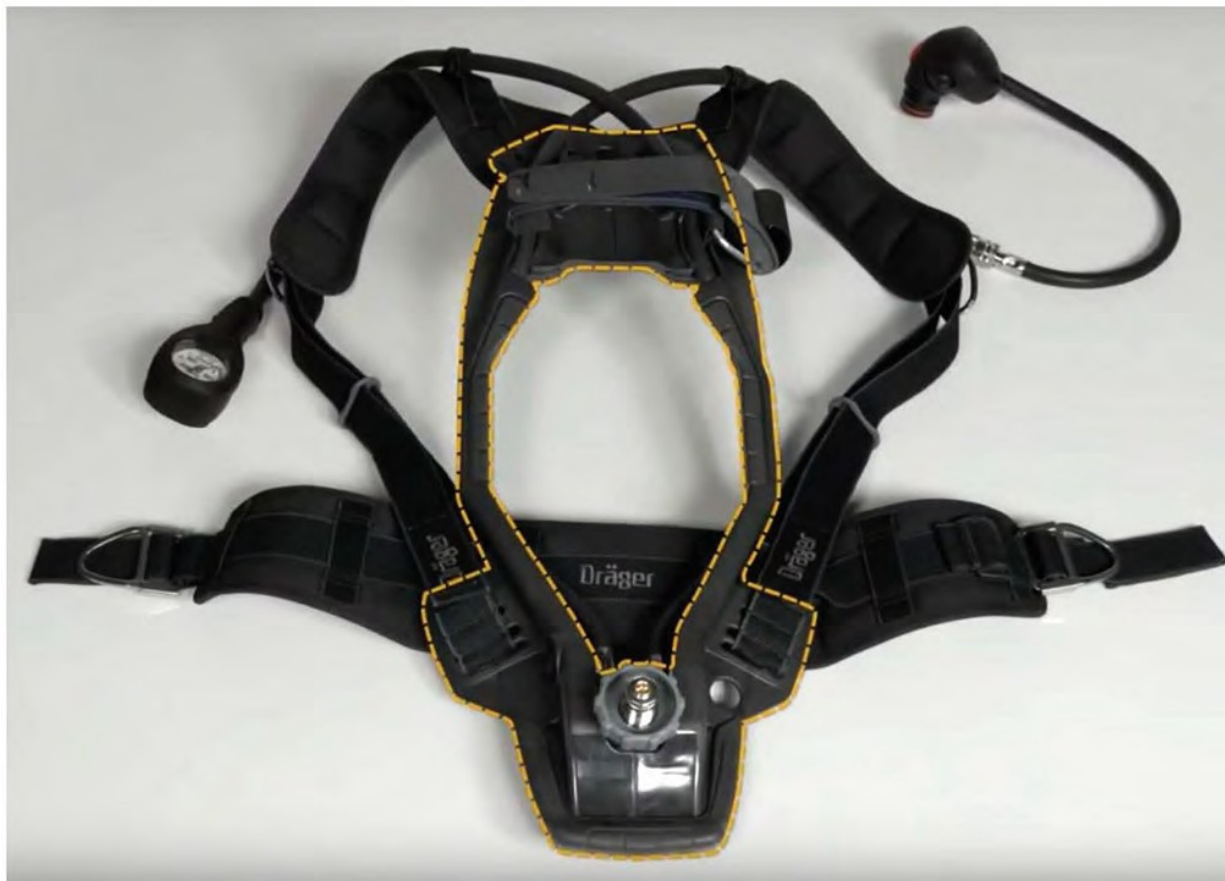
Fig. 5. Cadrul aparatului de respirație văzut din spate (cadrul evidențiat cu linie întreruptă). Părțile laterale ale cadrului au margini rotunjite, formând mânere, reductorul de presiune și conductele de presiune ridicata și joasa sunt ascunse în caneluri. Pozițiile conductelor (stânga-dreapta) pot fi schimbate între ele.
