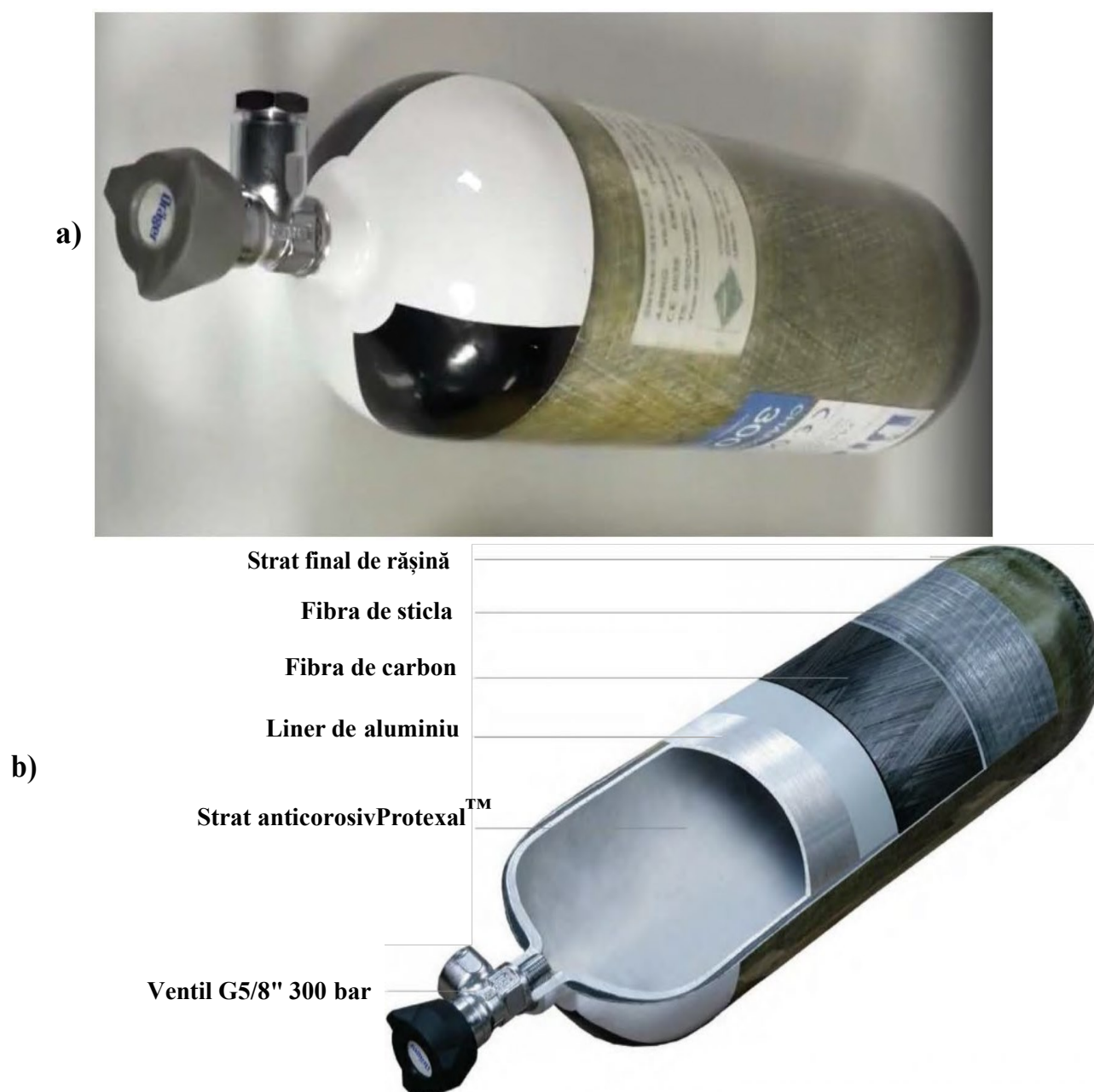
Fig. 7. Butelia de aer din material compozit: a) aspect general al buteliei cu ventilul în prim plan, b) schema buteliei cu indicarea materialelor folosite.
