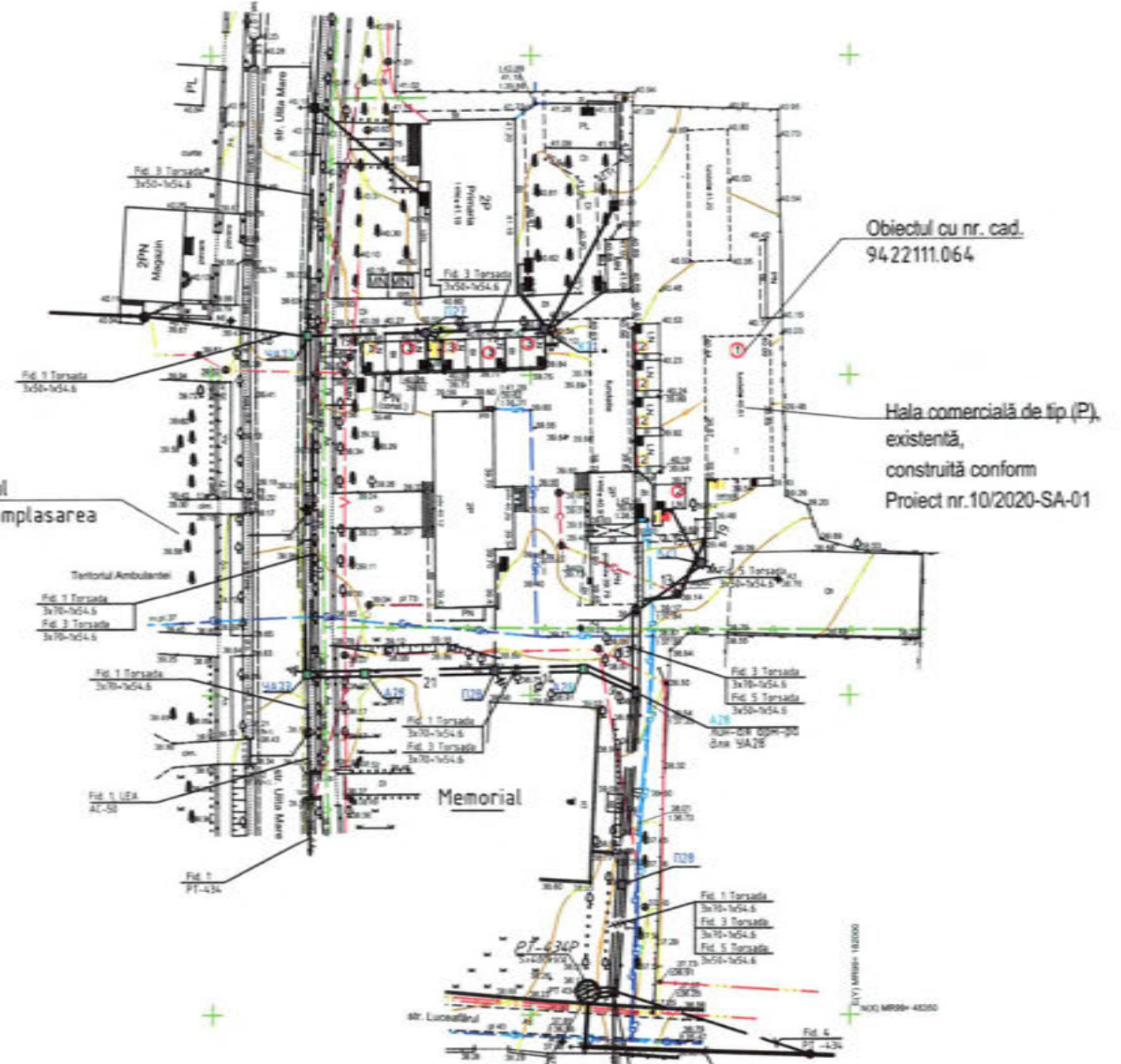
Plan topografic a zonei vizate pentru proiectare - rețele existente
