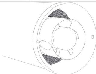
6. Выкрутить саморезы из фланца. Снять
