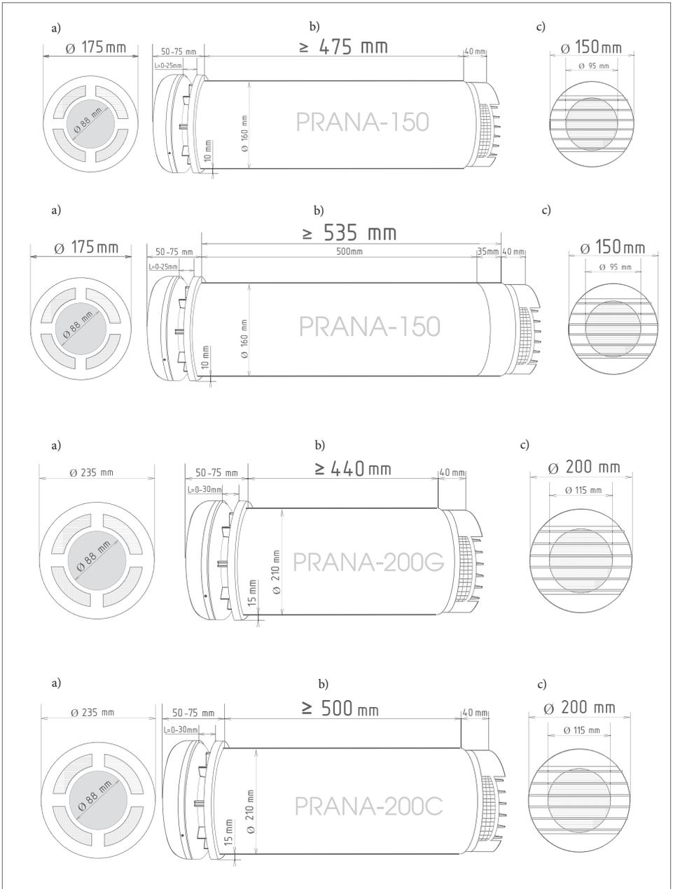
Рис. 3. Габариты и размеры системы вентиляции «PRANA-150», «PRANA-200G», «PRANA-200C»: а) вентиляционная решетка и воздухозаборник в помещении; б) моноблок, вид сбоку; в) вентиляционная решетка и воздухозаборник с улицы.
