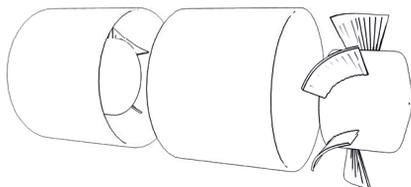
9. Вынуть лопасти из корпусов вентиляторов и очистить сухим способом.
