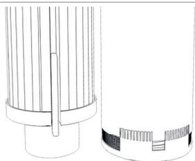
11. Подогрев конденсатаотвода (нагревательный элемент) должен находиться снизу у отверстия на корпусе.
