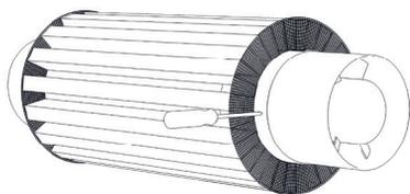
8. Вывернуть саморезы. Снять вентиляторы с обеих сторон.
