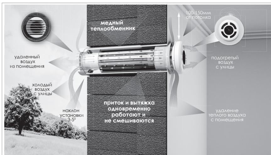
Рис.1. Принцип работы рекуператора PRANA-150, PRANA-200С, PRANA-200G
