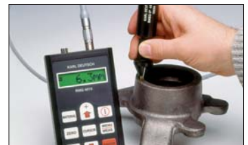
Messung eines senkrecht verlaufenden Risses an einer kleinen Messfläche
