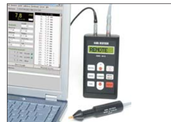
STATWIN 2002 mit PC-Verbindungs-kabel und Risstiefensonde RMSQ 0°
