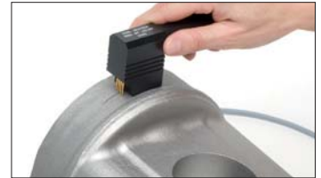
Risttiefenmessung an einem schräg verlaufenden Riss nach der Winkelbestimmung
