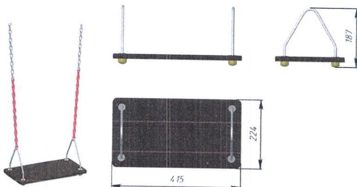
Scaunul este destinat copiilor cu vîrstă de la 3 ani. Constructia este constituită din carcasa din otel, sezut din HDPE – polietilena de inalta densitate fara componente toxice cu structura multistrat de diverse culori, cu grosimea de 10 mm, lanț galvanizat, balamale cu rulmenti de tip inchis.
