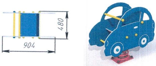
Balansoarul va fi destinat copiilor cu vîrstă de la 3 pînă la 10 ani. Constructia este constituita din bază inferioară, arc elicoidal, scaun cu speteaza, 2 protecții laterale ale scaunului în formă de "masinuta", bare - suporturi pentru mîini și picioare.
