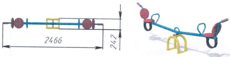
Balansoar "Greieras" Balansoar cu două locuri destinat copiilor cu vîrstă de la 3 ani. Componente: constructia este constituita din suportul de legănare cu elemente de amortizare din cauciuc, scaune si manere, baza metalica. Suportul de legănare al balansoarului este confectionat din țeavă de otel cu o
