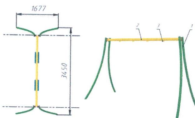
Componente: construcția este constituită din 2 seturi de suporturi metalice portante, unei bare metalice orizontale cu dispozitive de fixare pentru 2 suspensii (pentru 2 scaune + lanturi).
