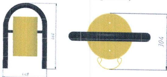
Constructia este constituita din carcasa din otel si cos pentru gunoi rotativ.
