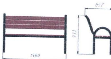
Constructia este constituita din carcasa din otel si scaun cu spatar din placaj rezistent la umiditate. Suprafata bancii este realizata din placaj rezistent la umiditate, cu grosimea de 30 mm.
