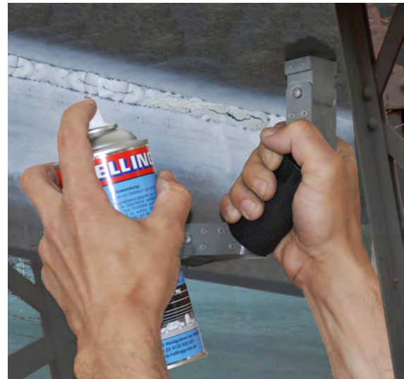
Schweißnahtprüfung mit schwarzer Magnetpulversuspension BW 333 und weißer Untergrundfarbe NR 104 A.
