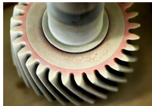
Fehleranzeige sichtbar gemacht mit Farb-Eindringssystem
