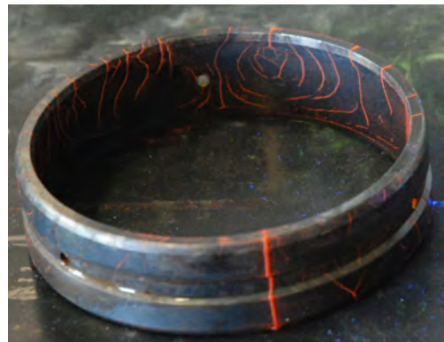
Rissanzeige sichtbar gemacht mit der roten Magnetpulversuspension Super Magna MEF 515 auf Wasserbasis
