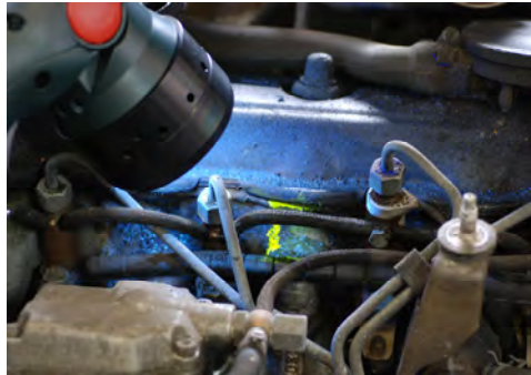
Dichtheitsprüfung am Kraftwagenmotor mit fluoreszierendem Konzentrat H 800
