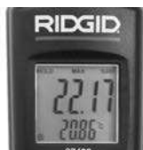
Figura 6 – Lecturas del termohigrómetro
