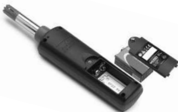
Figura 5 – Reemplazo de la batería
