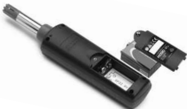
Figura 5 – Substituição da Pilha
