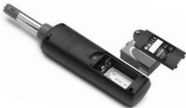
Figura 5 – Sostituzione della batteria
