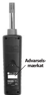
Fig. 2 - Bagsiden af micro HM-100 temperatur-/fugtighedsmåleren
