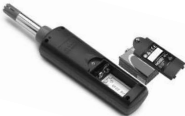
Figure 5 – Remplacement de la pile
