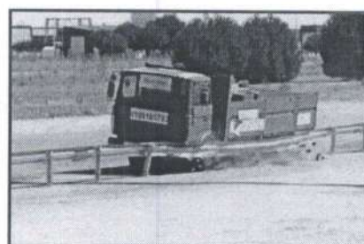
TB 42 Test de impact Camion 10.000 Kg., 70 Km/h și 15°
