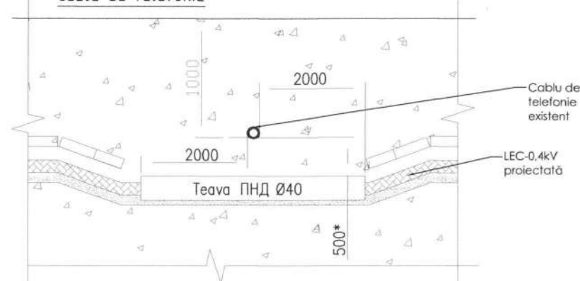
Intersecția LEC-0.4kV cu cablu de telefonie
