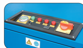
Контрольная панель управления. Control Panel.
