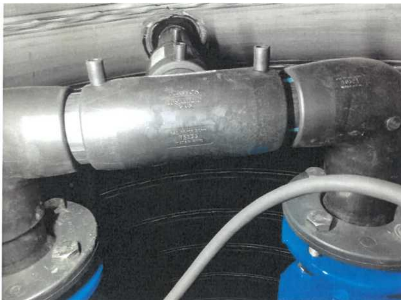
Figura 5: Specimen de încercare - țeavă PE de refulare
